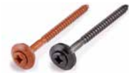
Inox schroef met Torx kop + rondel & neopreenring Vis Torx en inox + rondelle & anneau
