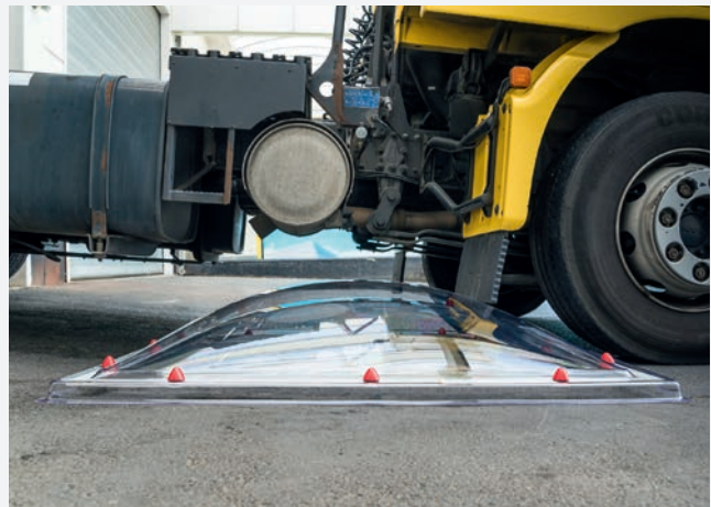
Test : un camion passe sur une coupole cuirassée en polycarbonate Skylux. La coupole se déforme mais ne casse pas, elle reprend ensuite sa forme originale.
