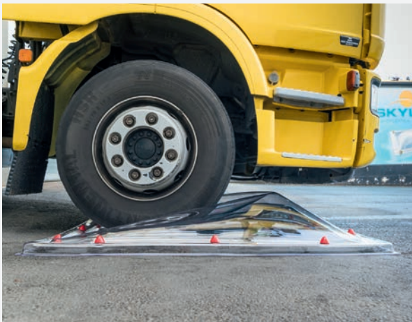
Test : un camion passe sur une coupole cuirassée en polycarbonate Skylux. La coupole se déforme mais ne casse pas, elle reprend ensuite sa forme originale.
